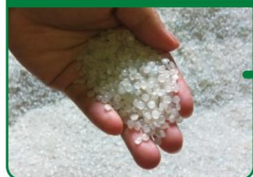
破碎後、熱で溶かして米粒状の大きさに再形成したペレットは、再生プラスチック原料の素材となります。
