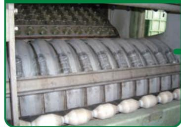
洗びん工場では種類ごとに分けてから、熱湯と苛性ソーダを使って洗浄します。
