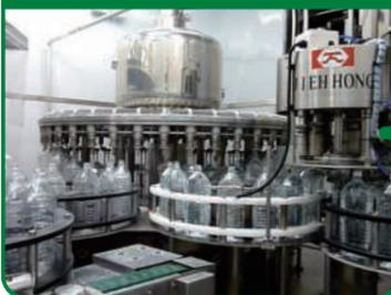
プリフォームに空気を充填して成型したペットボトルに、再び水を充填します。
