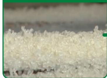
細かく破碎したペットボトルを、洗浄してからペレット化します。
