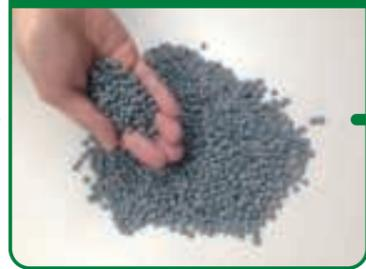
破碎後、熱で溶かして米粒状の大きさに再形成したペレットは、再生プラスチック原料の素材となります。
