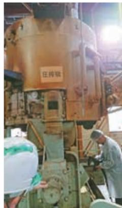
薬品を使わず圧力をかけて圧搾
